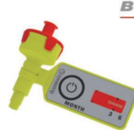
Rojo/amarillo. Con rosca de conexión UNF 1/4" 28G. Membrana del filtro de PTFE/PP con una porosidad de 1 µm y válvula antirretorno integrada de silicona. Con indicador de vida útil.
