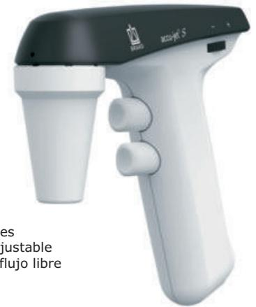
Para un pipeteo preciso de volúmenes grandes y pequeños. La velocidad ajustable del motor permite alternar entre el flujo libre y el soplado rápido del líquido.
