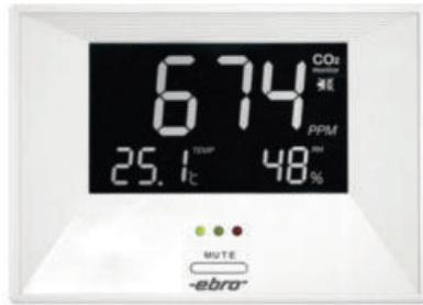
Para un control y evaluación fiables de la calidad del aire interior. Medición y visualización simultánea de la temperatura, concentración de CO<sub>2</sub> y humedad. La concentración de CO<sub>2</sub> en el aire es indicada adicionalmente por tres LEDs como buena, media o mala.
