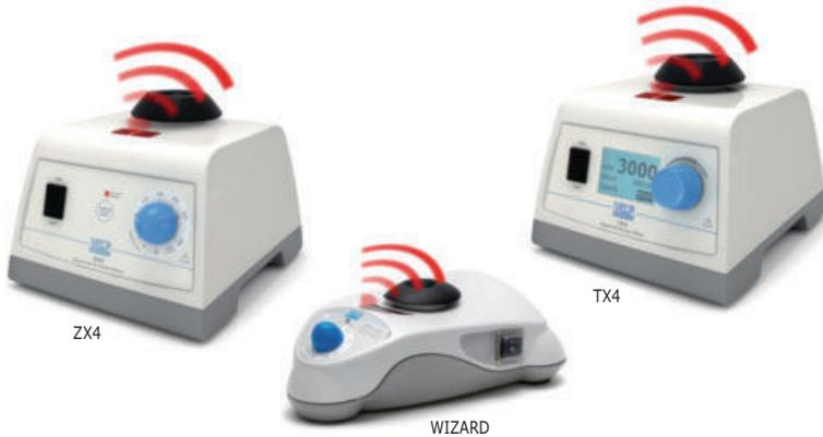
Agitadores vórtex con sensor IR patentado para el reconocimiento de muestras: el proceso de agitación se inicia automáticamente cuando el tubo de muestra se acerca al cabezal del vaso mezclador. Esto permite un trabajo sin fatiga, ya que la muestra no tiene que ser presionada en el dispositivo.
