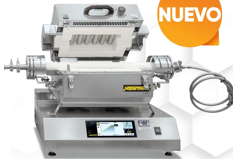
Los hornos tubulares pueden utilizarse para funcionamiento horizontal y, con un trípode vertical, también para funcionamiento vertical. El diseño dividido facilita el cambio del tubo de trabajo. Añadiendo diferentes paquetes de suministro de gas, se puede trabajar en una atmósfera de gas protector, con gases o en vacío. Además de los cómodos controladores estándar, también se pueden utilizar modernos controladores PLC para controlar el proceso.
