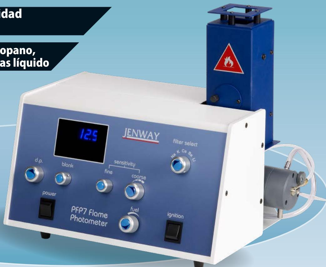
Fotómetro de llama de un solo canal y baja temperatura para su uso en la industria, la medicina y la educación. Con sistema electrónico integrado de seguridad contra fallos de llama para la seguridad de funcionamiento.
