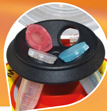
LLG-uniCFUGE 2/5 con rotor para tubos de 5 ml
