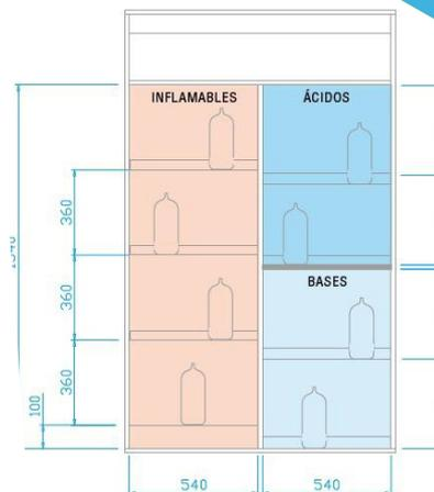
Armario de seguridad EXACTA para el almacenamiento de productos químicos combinados: inflamables (líquidos y sólidos), corrosivos y nocivos, con clase de resistencia al fuego según FWF de 90 minutos con certificado en 14470-1 (según nueva legislación APQ-10)
